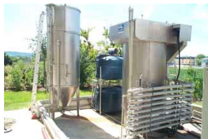
Processo di flottazione ad aria dissolta seguito da filtrazione in continuo nel trattamento di reflui industriali.
