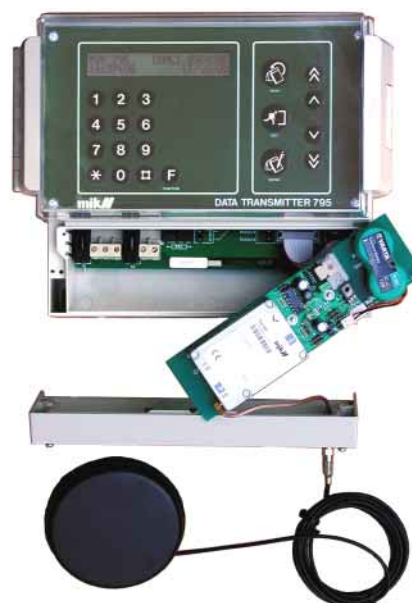
Unità di trasmissione dati con Modem GSM incorporato
